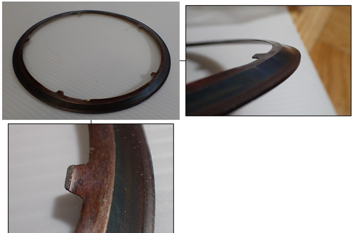
Rys. 4.20. Niekontrolowane zużycie talerzowej sprężyny dociskowej
