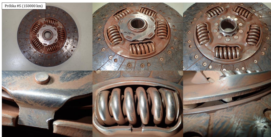
Rys. 4.15. Używany tłumik drgań 125816 (254 mm) po przejechaniu przez pojazd 150000 km
