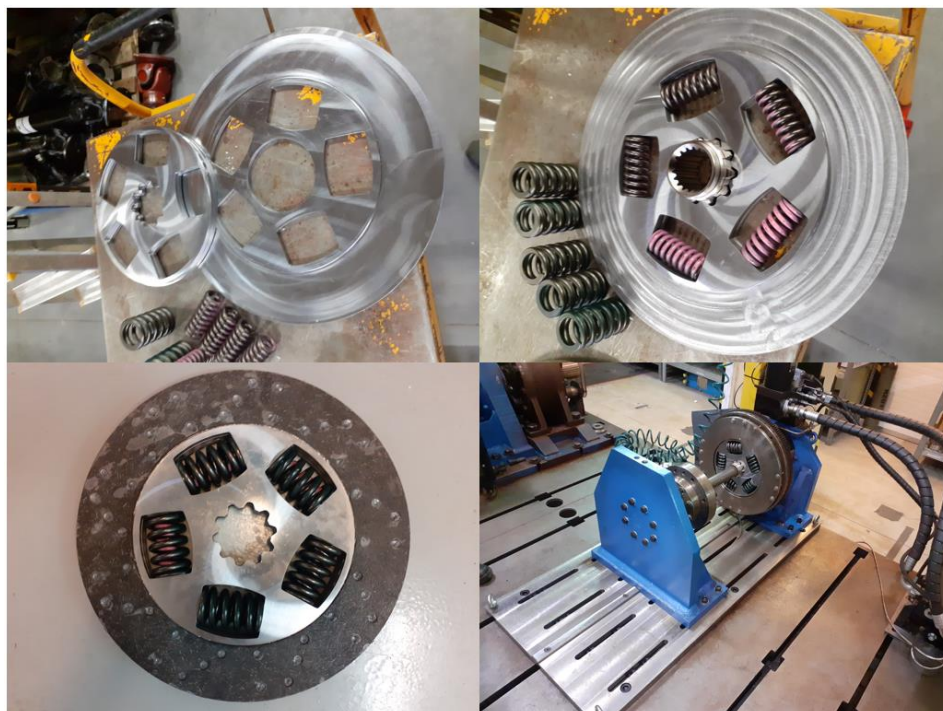
Rys. 4.39. Specjalna tarcza do pomiaru momentu tarcia generowanego przez stanowisko pomiarowe
