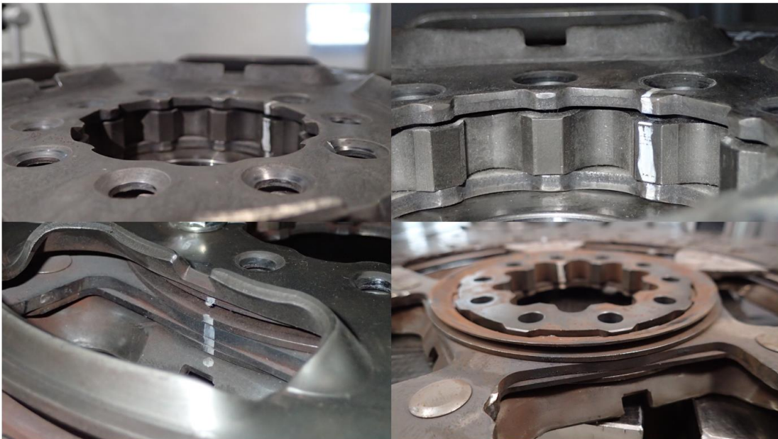
Rys. 4.12. Uniesiona tarcza zabierakowa po całkowitym rozprężeniu sprężyny dociskowej
