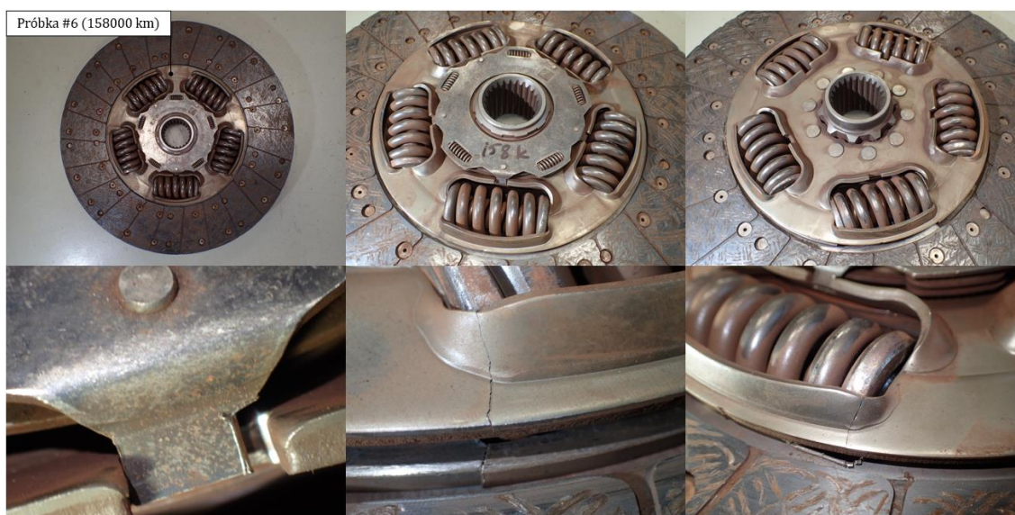
Rys. 4.16. Używany tłumik drgań 125816 (254 mm) po przejechaniu przez pojazd 158000 km
