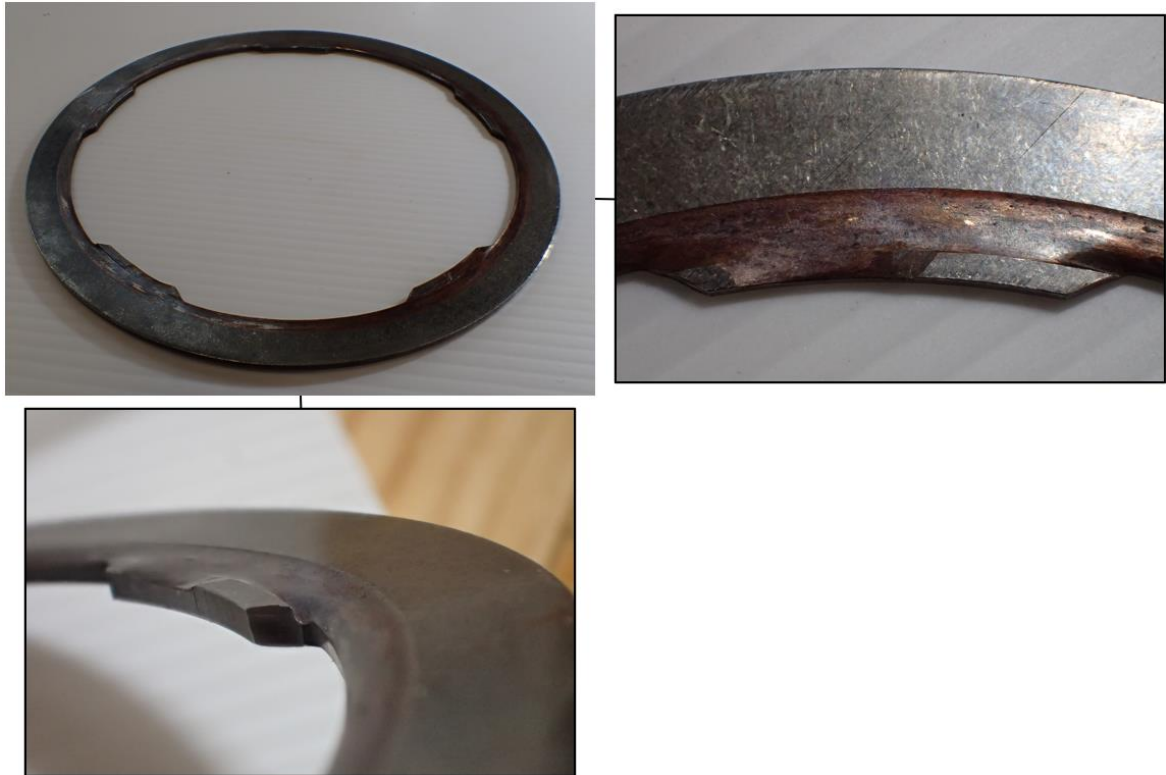
Rys. 4.19. Niekontrolowane zużycie pierścienia ciernego B
