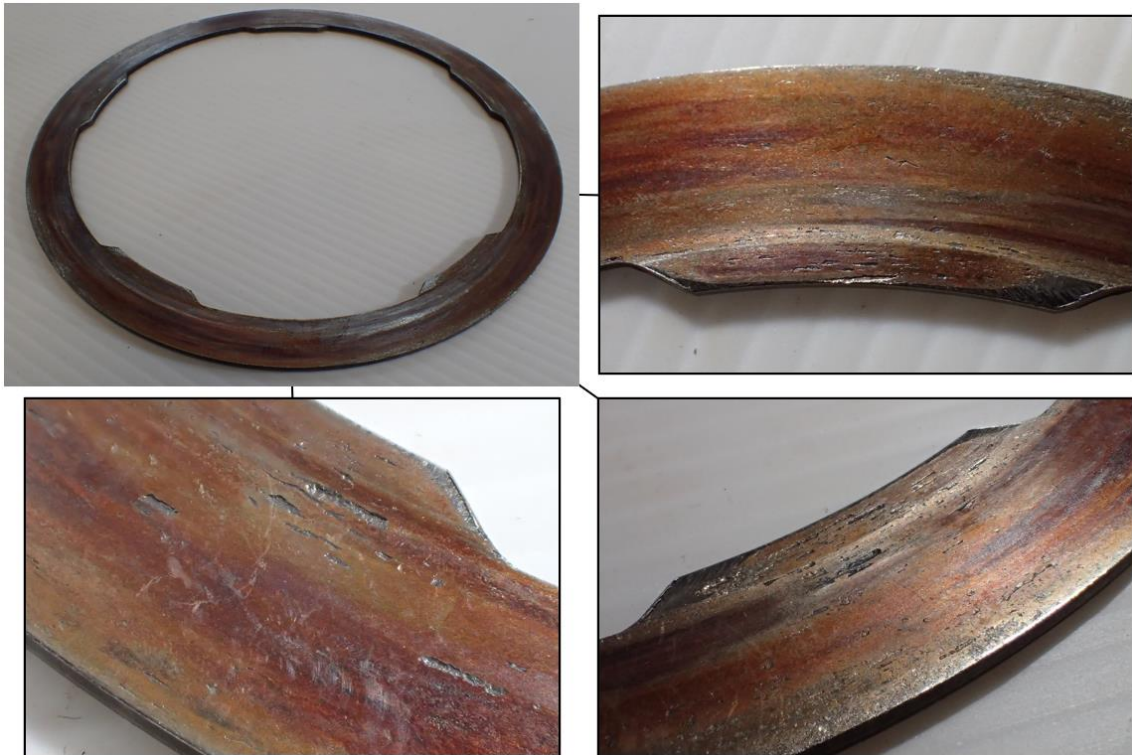
Rys. 4.17. Kontrolowane zużycie pierścienia ciernego A
