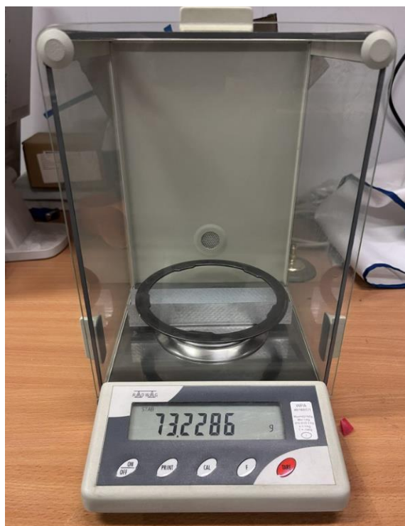
Rys. 4.5. Pomiar masy pierścienia za pomocą wagi WPA 40/160/C/1 (laboratorium Politechniki Gdańskiej)
