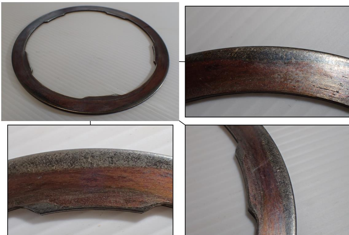
Rys. 4.18. Kontrolowane zużycie pierścienia ciernego B
